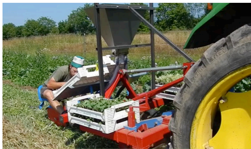
Repiquage avec la planteuse RMS et fertilisation localisée
